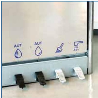
Einfache Steuerung durch Fußpedale. Gleichzeitige Reinigung von bis zu vier Spritzpistolen.
