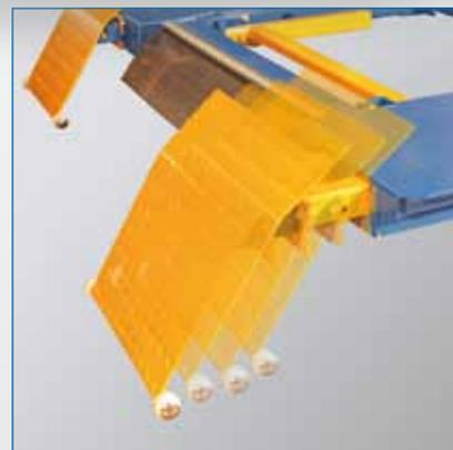
In der aufliegenden Version lassen sich die Auffahrrampen und Radaufläufen in vier Stufen positionieren. Damit kann die Bühne auf den jeweils gegebenen Radstand angepasst werden.
