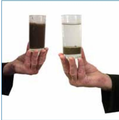
Saubere Reinigung des Systems: Wasser und Schmutzpartikel werden durch Sedimentation voneinander getrennt. Das Wasser fließt ab und der zurückbleibende Schlamm wird entfernt. Bei Bedarf kann ein Koagulieremittel eingesetzt werden um Restprodukte aufzufangen.
