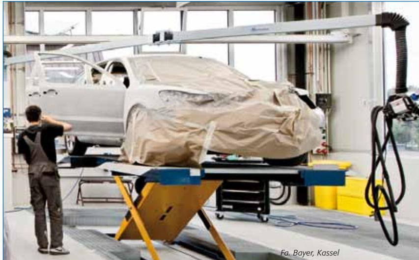
Die HLS 3200 ist mit einer Tragkraft von 3,2 to für schwere Fahrzeuge konstruiert. Das schafft Arbeitssicherheit und erschließt die Werkstatt für SUVs und Kleintransporter. Die erweiterte Standfläche ermöglicht auch die Aufnahme langer Fahrzeuge. Der stufenlose Hub optimiert Zugänglichkeit und ermüdungsfreies Arbeiten.
