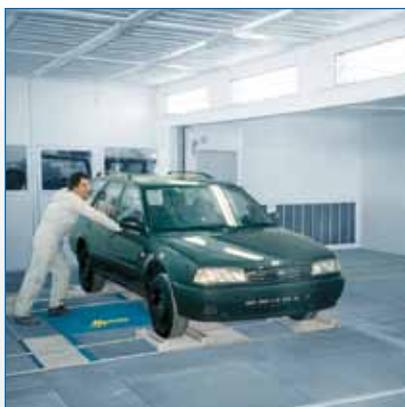
Das Fahrzeug ist leicht in den Trockner zu schieben. Die Hebebühne steht für das nächste Fahrzeug bereit.
