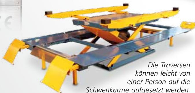
Die Traversen können leicht von einer Person auf die Schwenkarme aufgesetzt werden.
