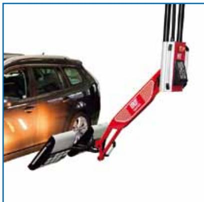
Die große Reichweite ermöglicht es, auch die Schweller zu trocknen.
