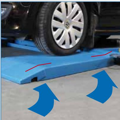
Die Doppelkeil-Rampe ermöglicht ein leichtes und beschädigungsfreies Befahren auch mit tiefergelegten Fahrzeugen.
