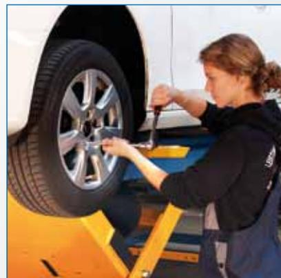
Die stufenlos einstellbare Arbeitshöhe sichert das ermüdungsfreie Arbeiten in aufrechter Haltung.
