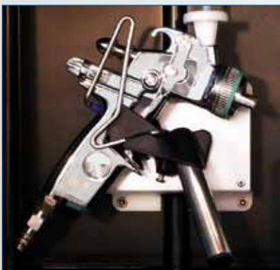
Der patentierte magnetische Pistolenhalter hält die Spritzpistole in optimaler Position in der Auto-Box. Beim Einsetzen wird die Pistole mit der Öffnung nach unten gehalten, so dass kein Lösemittel in die Luftkanäle eindringen kann.
