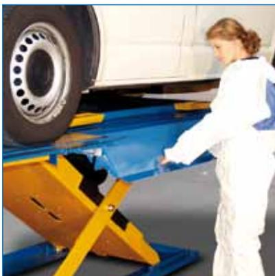
Die abklappbaren Rampen erleichtern den Zugang zum Fahrzeug im Schwellerbereich.
