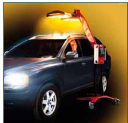
Die goldbelegten Reflektoren sind Voraussetzung dafür, dass die Infrarot-Trockner auch nach langem Gebrauch ihre Trockenkapazität beibehalten. Die neuen Hyperion Freiformreflektoren liefern bei reduziertem Stromverbrauch eine gleichmäßige Temperaturverteilung sowie eine größere Trocknungsfläche als konventionelle Reflektoren.
