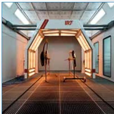
Der PowerCure ist an den Kabinenseiten in Schienen aufgehängt. So kann er sicher die Trockenstrecke abfahren.
