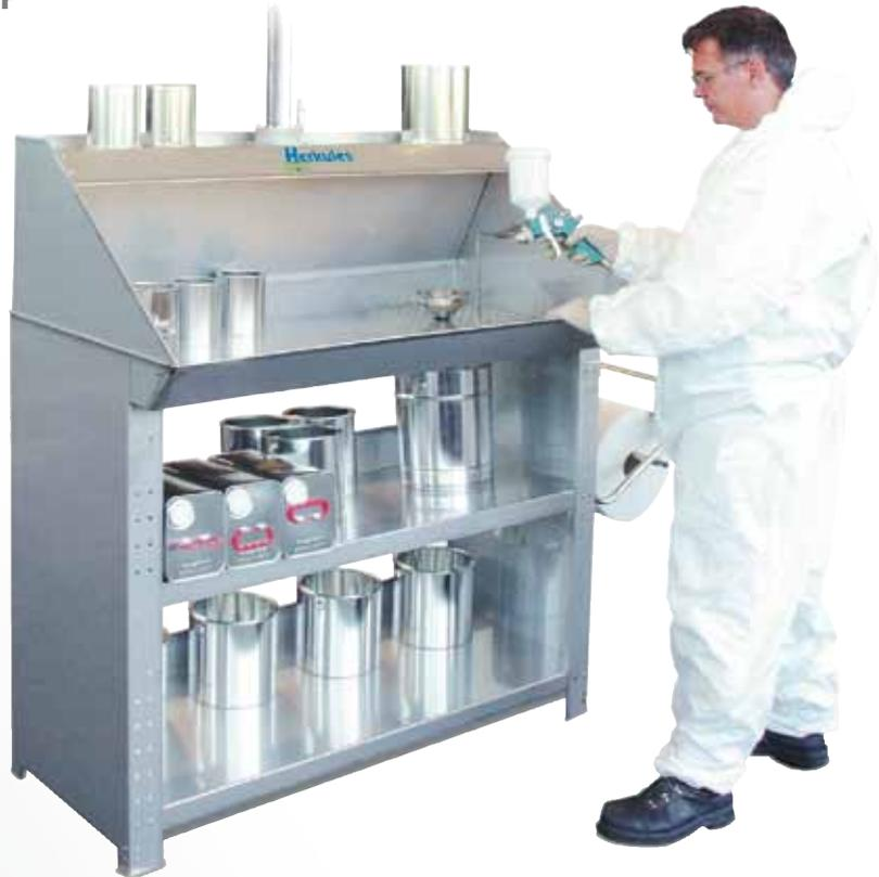
Die Absaugung kann an ein vorhandenes System angeschlossen werden. Herkules bietet eine pneumatische Absaugung als Zubehör.
