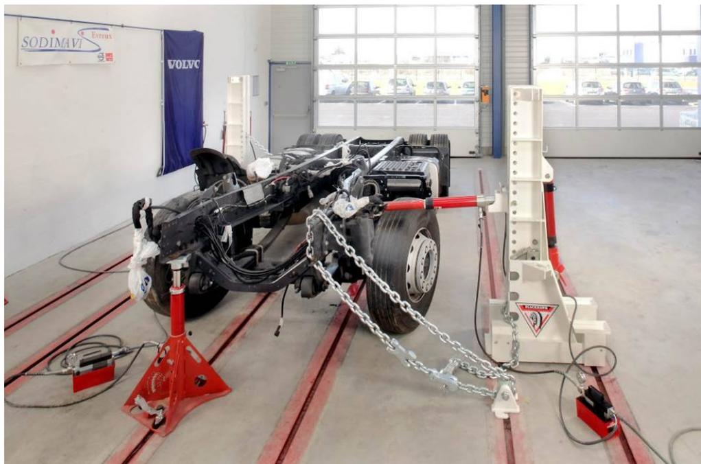
Horizontale und vertikale Züge mit 23t Zugkraft
