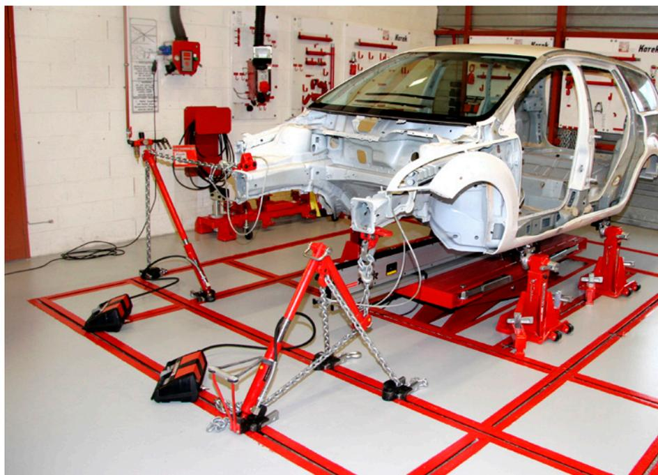
Dank seine 4 Säulen auf Räder mit ultra robusten Klemmen erhöht, hält der Power lok® das Fahrzeug auf dem stabilen Korek®-Rahmen fest. Sehr zugänglich geworden, hält der Unterboden des Fahrzeugs eine feste Position an vom Anfang bis zum Ende einer effizienten, schnellen und genauen Reparatur.
