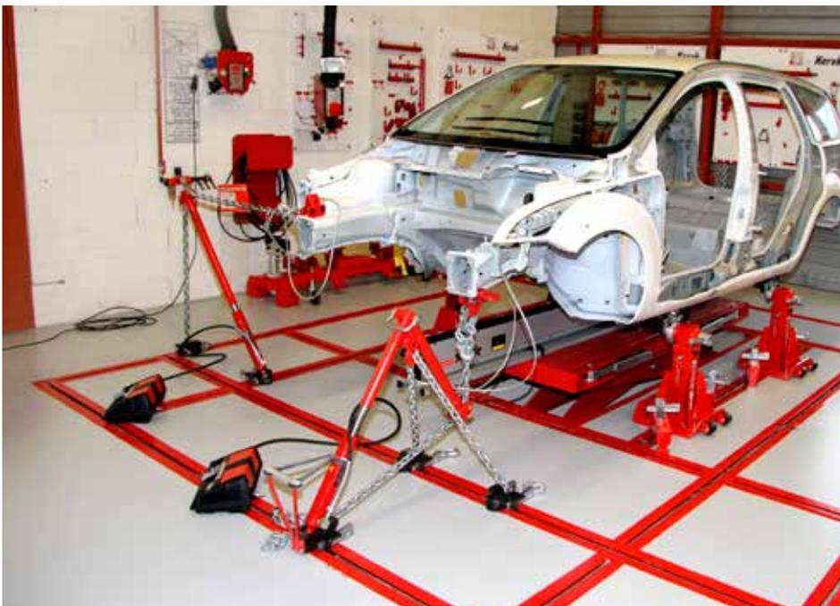
Dank seine 4 Säulen auf Rädern mit ultra robusten Klemmen erhöht, hält der Power lok® das Fahrzeug auf dem stabilen Korek®-Rahmen fest. Sehr zugänglich geworden, hält der Unterboden des Fahrzeugs eine feste Position an von Anfang bis zum Ende einer effizienten, schnellen und genauen Reparatur.
